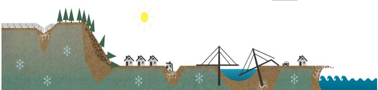
Abb. 2 Schäden durch das Auftauen von Permafrostboden
