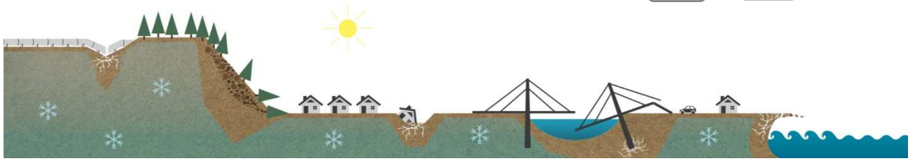
Abb. 3 Schäden durch das Auftauen von Permafrostboden
